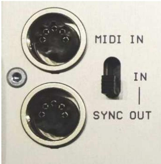
An der Sync-Buchse wird dann ein Sync-Out Signal für andere Geräte mit Sync-In Eingang ausgegeben.
