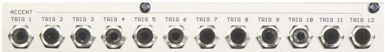
Jeder Triggerausgang (Trig2, Trig3, ...) hat eine Ausgangsamplitude von 4,2 Volt, wenn kein Accent programmiert ist. Die Impulslänge beträgt 10ms. Mit programmierten Accent auf den jeweiligen Step, beträgt die Ausgangsamplitude 4,2 bis 11,5Volt.
