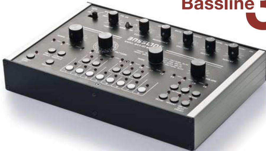
Die Rosenheimer Analogschmiede Acidlab beschert uns mit der Bassline 3 einen Nachbau der legendären TB303 von Roland, die schon auf dem ersten Blick einen sehr guten Eindruck macht. Eingepackt in ein Aluminiumgehäuse tummeln sich auf der Oberfläche mehrere verschraubte Metallpotis und Kunststoffbuttons, welche sich auch im Livebetrieb sehr gut bedienen lassen. Die Haptik ist exzellent.
