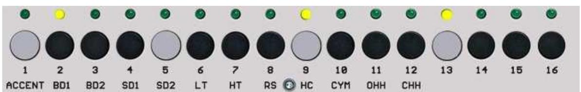
Das jeweils aktive Pattern wird mit der LED über dem Taster blinkend als Aktives angezeigt und wird nach Ablauf des vorangegangenen Pattern abgespielt.
