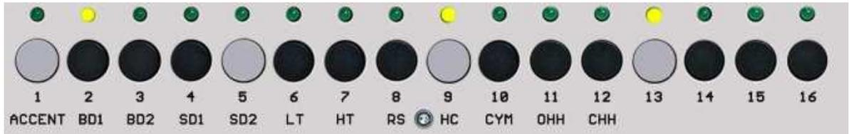
Das jeweils aktive Pattern wird mit der LED über dem Taster blinkend als Aktives angezeigt. Beim Drücken eines neuen Patterns leuchtet diese LED zunächst dauerhaft. Nach Ablauf des letzten Steps wechselt der Sequenzer zum neu gewählten Pattern. Jetzt blinkt diese LED.
