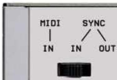
An der Sync-Buchse wird dann ein Sync-Out Signal für andere Geräte mit Sync-In Eingang ausgegeben.
