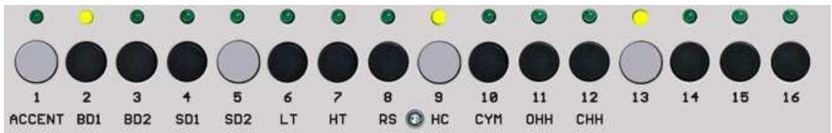
Das aktuelle Pattern wird mit den LEDs 1 bis 16 angezeigt.
