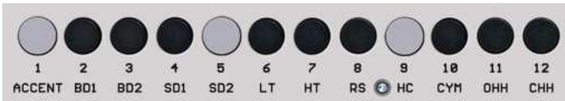
Mit gedrückter Inst./Select-Taste wird das ausgewählte Instrument (oder Accent) mit der LED über der Instrumententaste angezeigt.
