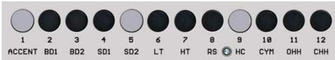
Durch Drücken der Instrumententasten (BD1,BD2,SD1, ...) werden diese in dem Moment des Durchlaufens geschrieben. Mit der Taste Accent (AC) wird ein Accent zu den an dieser Stelle programmierten Instrumenten hinzugefügt. Entsprechend zeigen die LEDs über den Instrumententasten die jeweilige Programmierung der Steps an. Bei nochmaliger Programmierung eines Instruments auf den gleichen Step, bleibt die Programmierung bestehen.
