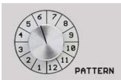
Es stehen 12 Pattern-Groups zur Verfügung die mit einem Drehschalter ausgewählt werden können. Eine Pattern-Group wiederum beinhaltet 16 Pattern welche über die Patterntasten (1-16) selektiert werden.
