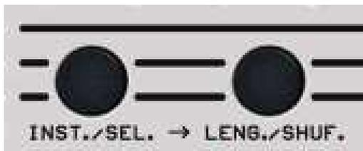
Auf den LEDs der Step-Tasten (1-16), zeigen die LEDs 1-5 die Shuffle-Einstellung der ersten Shuffle-Art. Die LEDs 8-12 zeigen die Shuffle-Einstellung der zweiten Shuffle-Art. Mit den dazugehörigen Step-Tastern 1-5 und 8-12, lässt sich der Shuffle bei gedrückt gehaltenen Tasten Instr./Select und Length/Shuffle verstellen. Wenn die Shuffle-Einstellung auf den Steps 1 und 8 steht gibt es keinen Shuffle.
