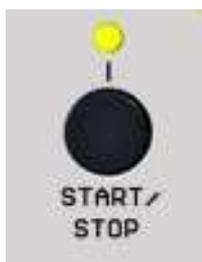
Start/Stop funktioniert in jedem Modus und setzt das Pattern auf den Startpunkt, also Step 1 des aktuellen Patterns zurück.
