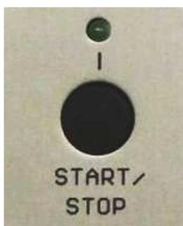
Start/Stop funktioniert in jedem Modus und setzt das Pattern auf den Startpunkt, also Step 1 des aktuellen Patterns zurück.
