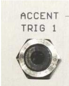
Accent/Trig1 Out ist in erster Linie zum Ansteuern von Trigger- oder Accent-Eingängen von Drum-Modulen, Gate-/Trigger-Eingänge analoger Synthesizer oder Eingänge vom Modular-System gedacht.
