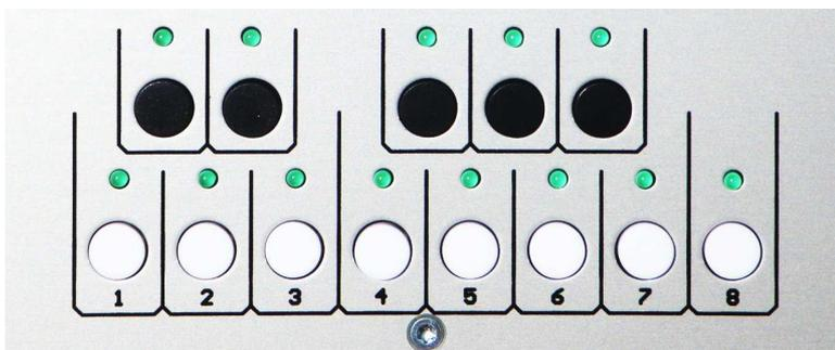
Auf den LEDs über den ersten 4 Stellen der Klaviatur wird einer der 4 möglichen Scale/Teiler angezeigt.
